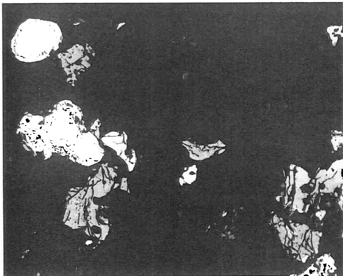
Figura 4.4.6 - Micrografia do material obtido no ensaio TF-06 (34% Sm / 1200°C/ 2h). Observar a presença de três fases: branco: Co; amarelo: \text{Sm}_2\text{Co}_{17} ; azul e marrom: \text{SmCo}_5 . Ataque de nital, 2%. (272x).
